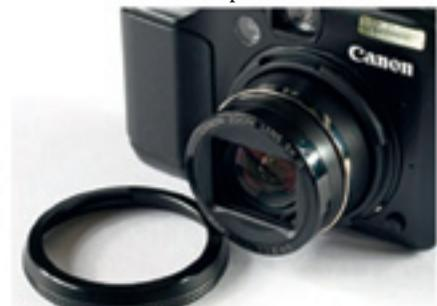
В правом нижнем углу находится кнопка, нажав которую можно снять защитное кольцо и получить доступ к креплению байонетного типа. Оно позволяет устанавливать дополнительную оптику – телеконвертер TC-DC58D (1.4x) через переходник LA-DC58K.
