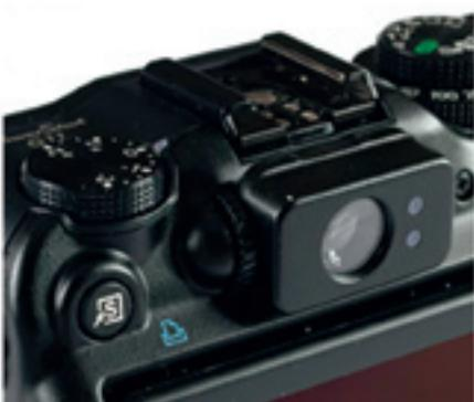
Камера оснащена оптическим видоискателем. Это большая редкость – в наше время, даже если ты видишь на камере видоискатель, велика вероятность, что он окажется цифровым. Конечно, у цифрового видоискателя есть свои плюсы – на экранчик может выводиться масса разнообразной информации, да и изображение ближе к тому, что ты получишь
