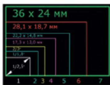
За стандарт берут размер узкопленочного кадра 36x24 мм. Камера с таким значением является полноматричной (Full frame). Кроп-фактор – коэффициент, показывающий насколько размер матрицы фотоаппарата меньше размера узкопленочного кадра.
